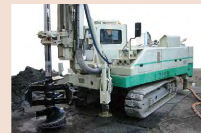
小型単軸地盤改良機
