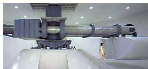
大型遠心模型振動実験載荷試験装置
