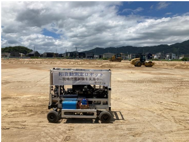
図 1. 自動透過型 RI 計測ロボット
