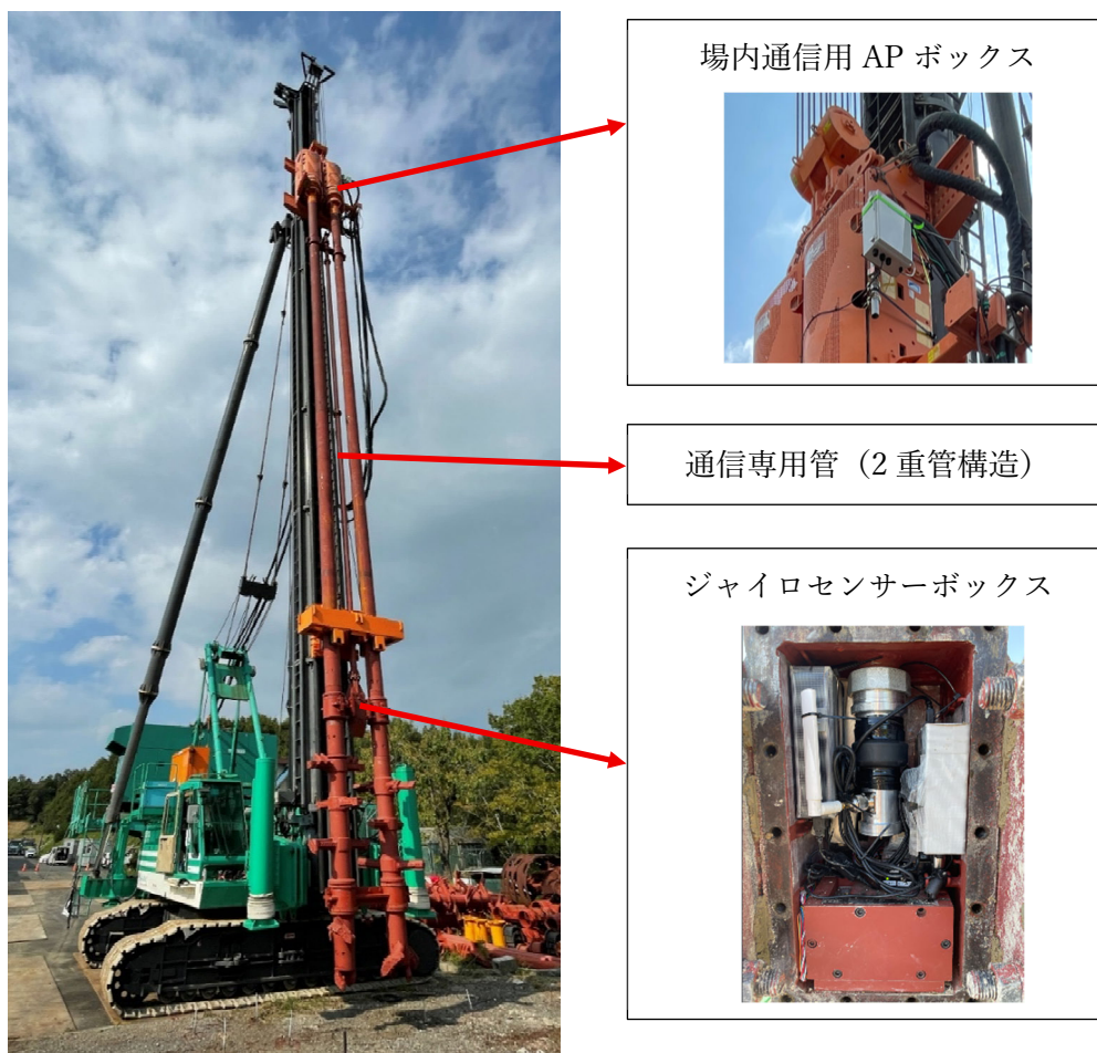
図 1. 鉛直精度リアルタイムモニタリングシステム概要
