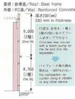
外壁施工概要/Plans for Placement
