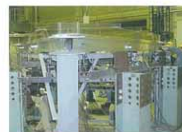
ドーム耐力試験
