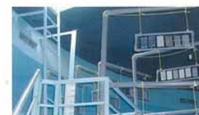
水道用PCタンク内での暴露試験
