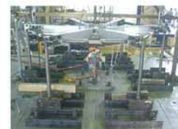
接合部確認試験
