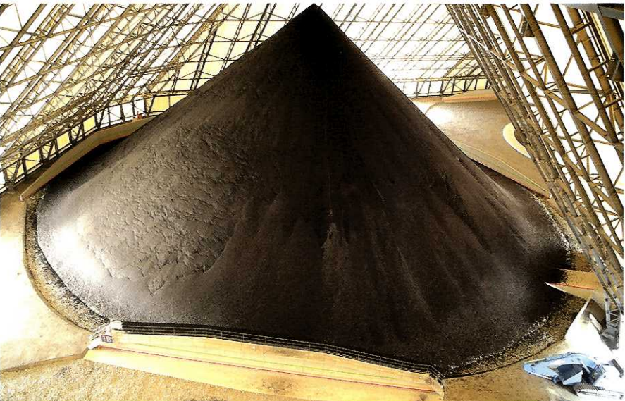
改良地盤上に積み付けた石炭山
