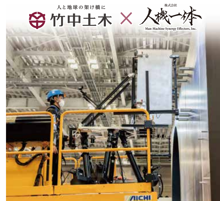
開発が進む重作業ロボット「人機スチュワートプラットフォーム」
