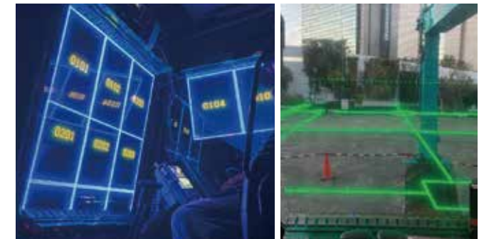
コックピットシステム操縦席からのディスプレイイメージ(左:夜間、右:昼間)
