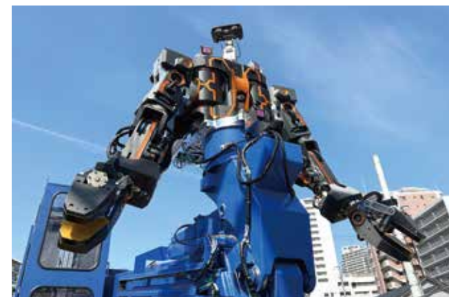
人型重機ロボットの土木分野への活用を目指して
