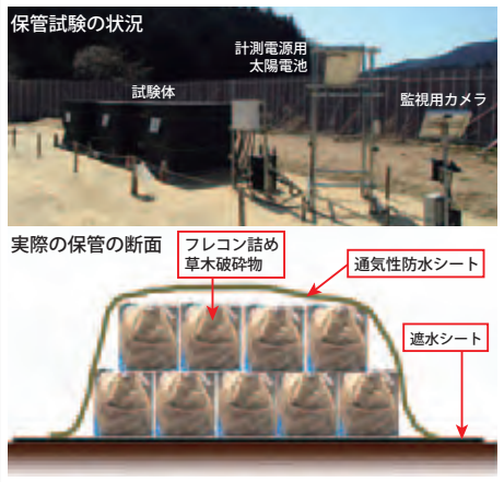
通気性防水シートを使用した草木チップ圧縮保管による廃棄物減容化とバイオマス燃料化
