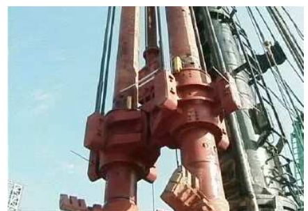
ベアリング式連結軸受けとワイヤ定着部
