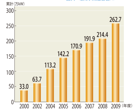
《日本の太陽光発電導入量の推移》 出典：電気事業連合会HP
